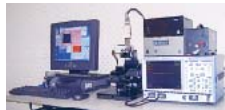
パルス励起型超音波音速顕微鏡の1号試作機
