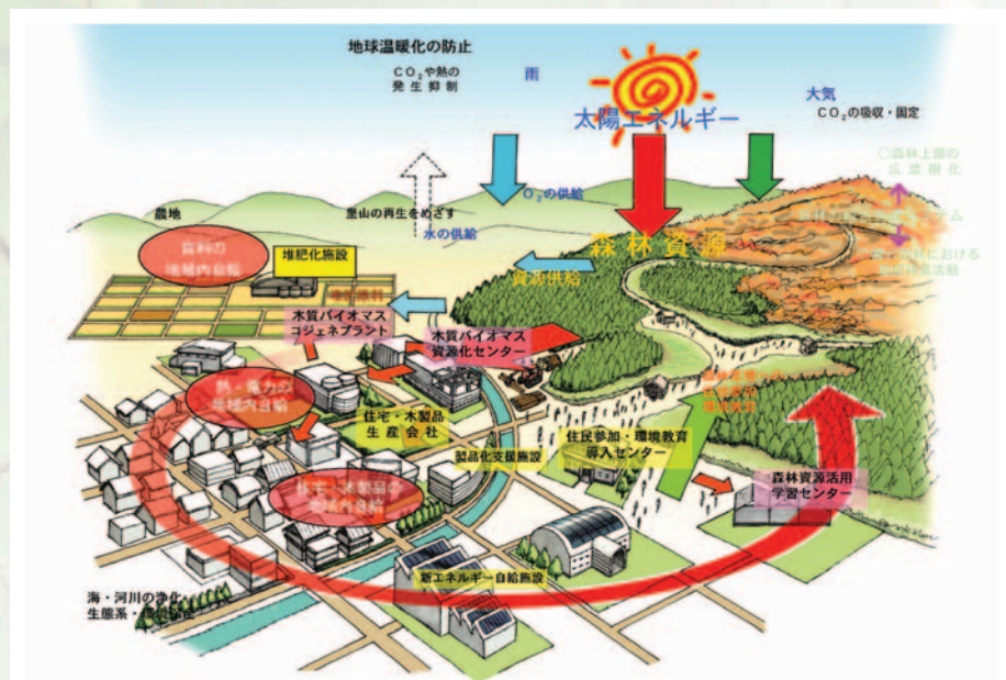
図1 小規模森林資源を有する地域に適したバイオマス利活用システムの概念図
