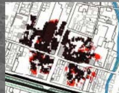
図2: 防災まちづくり推進のための延焼シミュレーションの例
