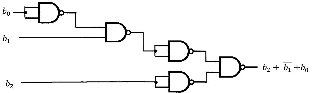
別解  $\overline{b_1} + (b_0 + b_2)$  に変形することにより以下の 5 個の NAND ゲートで構成される。
