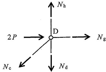
節点Dにおける水平方向（X方向）の釣合いより，
