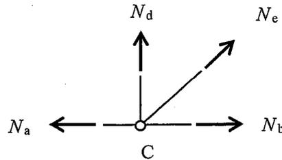
節点Aおよび節点Cにおける力の釣合い (上図) より, 部材dの軸力  $N_d$  を求める。まず, 節点Aにおける鉛直方向 (Y方向), 水平方向 (X方向) の力の釣合いより,
