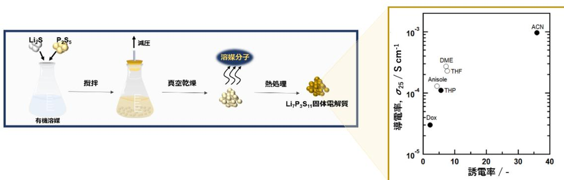
タイトル：液相合成法により調製した  $\text{Li}_7\text{P}_3\text{S}_{11}$  固体電解質の導電率
