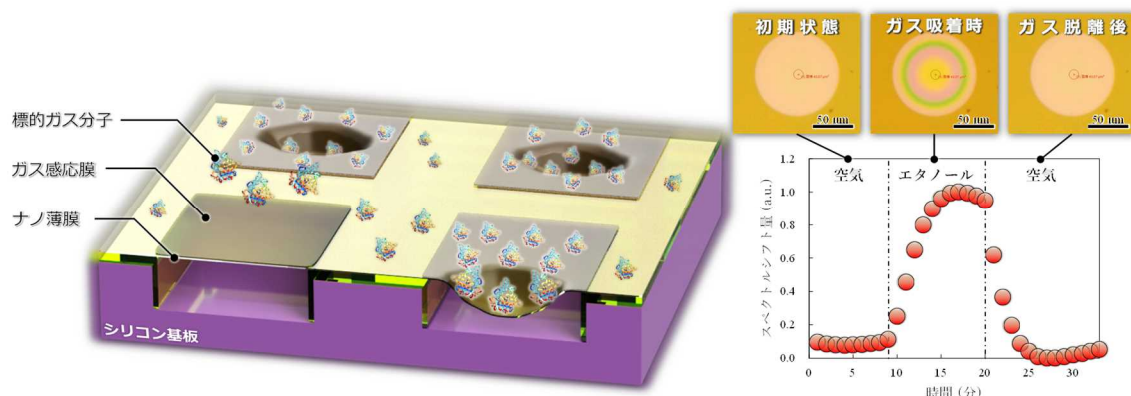
微量のガス分子をナノ薄膜表面に捉えて検出する IoT 化学センサ
