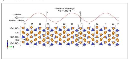
**タイトル**:シリケート系蛍光体の IC 相の結晶構造 キャプション: *b*-方向に 4.11 倍の非整数倍周期を有し、MO<sub>4</sub>の傾きの違いから、T,S,U が繰り返す周期構造になっている。
