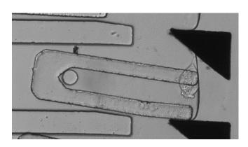
動画:ツリガネムシへの微小ハーネス組み付けとツリガネムシによる運動変換 動画キャプション:可動な微小構造(ハーネス)がツリガネムシに組み付けられる。続け て微生物融合のアプローチにより、ツリガネムシの直線運動がハーネスの回転往復運動に 変換される。
