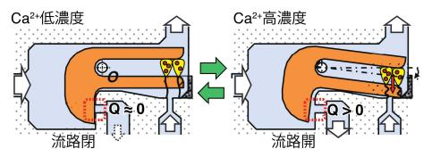
タイトル:ツリガネムシを組み込んで周囲カルシウムイオンに応答するマイクロバルブ キャプション:低カルシウムイオン濃度では、流路が構造により閉じている(左)。ツリガ ネムシが高カルシウムイオン濃度で収縮し、流路を開く(右)。
