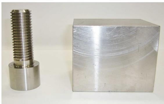
**図 3** 多軸鍛造法で作製した超高強度 2 種純チタンの大型材(約 1000cm<sup>3</sup>)とボルトサンプルの例。
