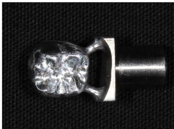
**図 4** 超高強度 2 種純チタンで作製した歯科用クラウン（かぶせ物（図 1 参照））
