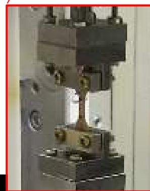
小型引張試験機を製作し，引張試験とX線CT撮像を同じタイミングで実施する。
