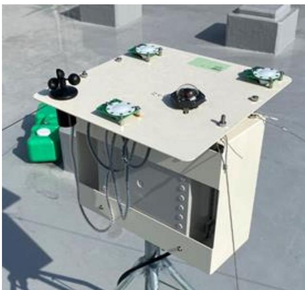
図1 フィールド試験中の雲影センサ（全天空カメラを日射計）
