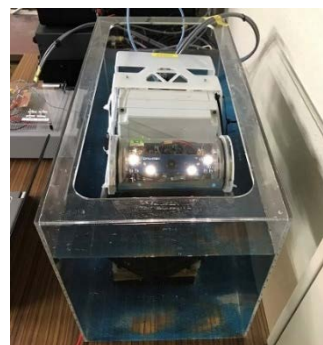
図 3：給電ステーションに着底した水中ドローンへの給電実験
