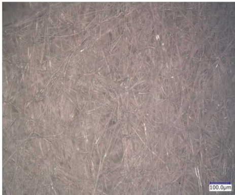
不織布マスクのフィルタ部の繊維構造 繊維間 0.5～15 \mu\text{m} 、繊維太さ:約5 \mu\text{m} 資料提供:大王製紙株式会社
