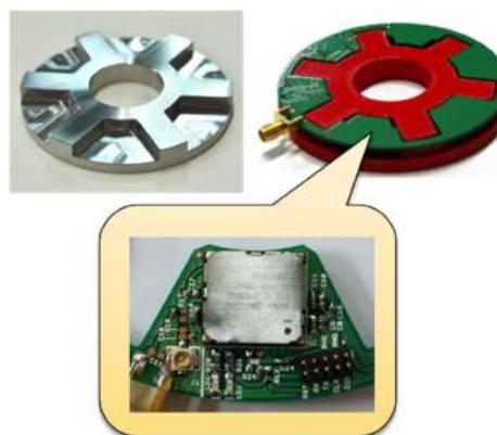
図2 作成したセンサ座金と回路基板
