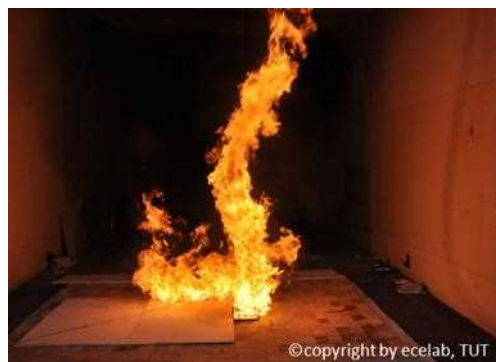
大きな風洞での火災旋風
