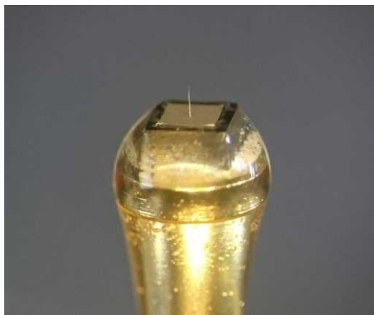
1ミリ角のシリコンブロック上に形成した世界で最も細い 5マイクロメートルの脳計測用針状電極の顕微鏡写真
