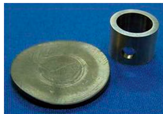
カーボンブラックを添加した PTFE 複合材料 と摩擦相手のリング試験片
