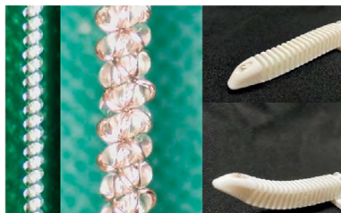
熱で駆動される釣糸人工筋アクチュエータ：釣糸人工筋は熱で可逆的に大きく収縮 (10%-20%) し、ロボットや運動補助装具への応用が期待されます
