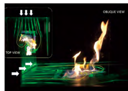
図3 火災旋風の模型実験事例
