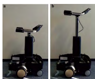
支援ロボットの側面図 (a) 肘置きが低い状態 (b) 肘置きが高い状態
