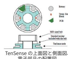
TenSense の上面図と側面図、電子部品の配置図
