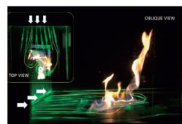
図 3 火災旋風の模型実験事例
