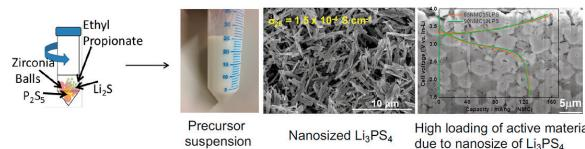
図1 液相法による硫化物固体電解質合成と電極複合体の作成
