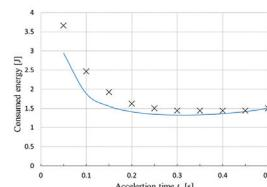
図2：S字加減速軌道において加減速時間(t<sub>a</sub>)の最適化により消費電力量を低減（実線：理論値、×：60回実験値の平均）
