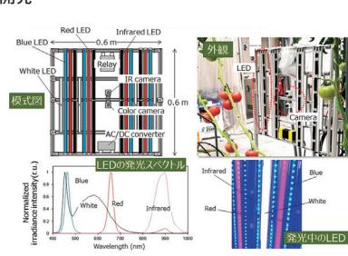
多元的画像計測装置の概略
