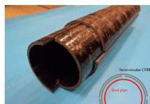
CFRP 製補剛材：二重半割管形状の
