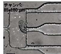
PDMSマイクロチャンバ中に選択的に固定した1個体のツリガネムシ
