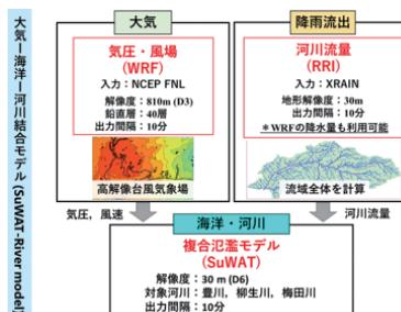
構築した大気－海洋－河川結合モデル（SuWAT-River model）
