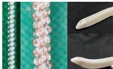
熱で駆動される釣糸人工筋アクチュエータ：釣糸人工筋は熱で可逆的に大きく収縮(10%-20%)し、ロボットや運動補助装具への応用が期待されます
