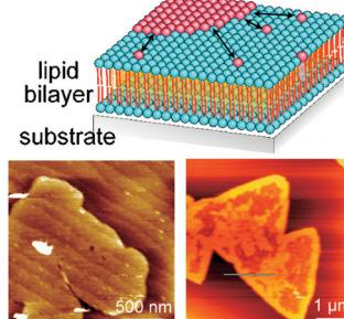
支持脂質二重膜 (SLB) と膜内分子拡散・ドメイン形成の模式図 (上) と、固体基板表面の影響を受けて形成される膜内 2 次元ドメインの AFM 像 (下)
