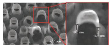
ナノチューブ構造を有する BTO 膜の傾斜 SEM 画像
