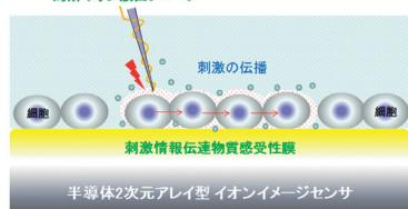
電気化学システムが化学刺激によって生きた細胞を観察するイメージ
