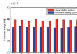
図1：非線形すべり面を用いることで制御性能を維持しつつ消費電力量を低減
