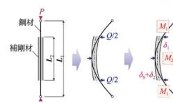
耐力向上のメカニズム：鋼部材の一部を CFRP 製補剛材で覆う座屈時の曲げ変形を拘束、圧縮耐力が向上
