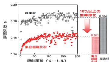
図1 集合組織化材と従来材の摺動性
