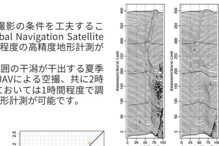
UAVによる干潟の地形変化の調査結果(2): 2週間での干潟の断面地形の変化
