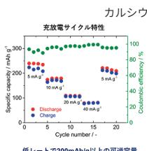
カルシウムイオン電池用新規正極材料の検討例（酸化バナジウム V<sub>6</sub>O<sub>13</sub>）
