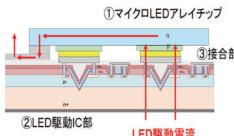
図1 LED駆動電流の経路
