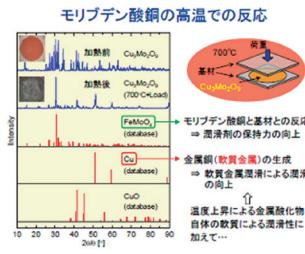
モリブデン酸銅高温潤滑性のメカニズム
