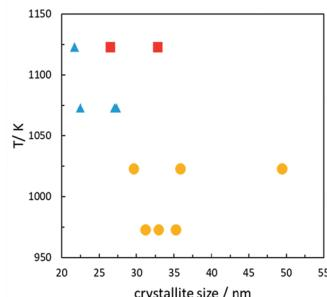
図1 BaEu<sub>2</sub>Mn<sub>2</sub>O<sub>7</sub>の転移温度と結晶子径の関係
