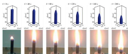
可視化した燃焼中の試料の形状変化過程。
