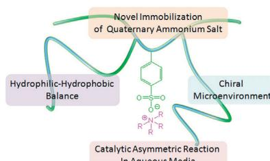
水系反応に適した高分子固定化触媒の特徴
