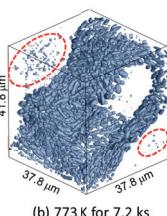
熱処理によるAl-Si 鋳造合金中のSi粒子の形態変化
