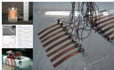
水中動作する IPMC アクチュエータの応用例：有限回転モータ、エイ型ロボットの開発、四足歩行ロボット
