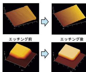
図2 近接場光エッティングによる平滑化
