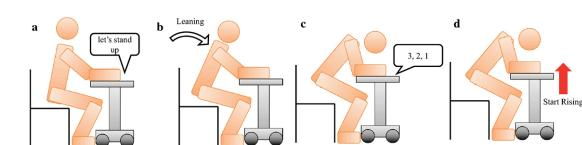
音声誘導・支援の手順 (a) 座位時の音声誘導「立ち上がりましょう」(b) ユーザの前傾 (c) 前傾終了時の音声誘導「3、2、1」(d) 音声指導後の肘置きの上昇
