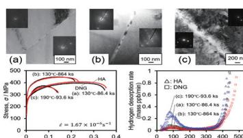
図2 時効条件により粒界近傍組織を変化させたアルミニウム合金のTEM成像、低ひずみ速度引張試験、昇温脱離分析
