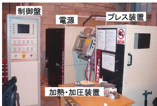
図12 熱間材料機械特性測定装置
