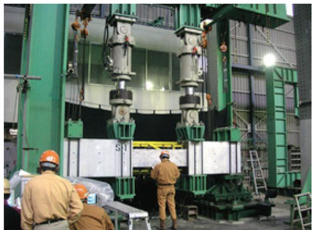
写真-5 RC梁の構造実験風景
