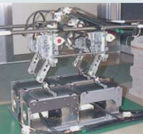
【図1】四足歩行ロボットでの適応制御の実験 日本ロボット学会誌(vol. 17, pp. 595-603, 1999)より改変
