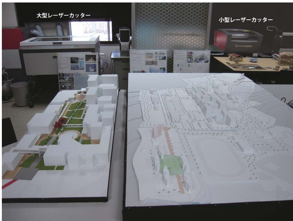
2台のレーザーカッターはプリンタ感覚で使える 出力は左が60WでA1サイズ程度、右が30WでA3サイズ程度が切断・加工できる
