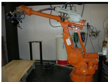
ロボティクスラボ ロボットアームに CNC 加工機とウォータージェットを装着して金属や石をカット
