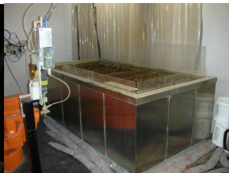
ロボティクスラボ ロボットアームに CNC 加工機とウォータージェットを装着して金属や石をカット
